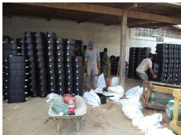
Foto 03: montagem das caixas dos hidrômetros.
