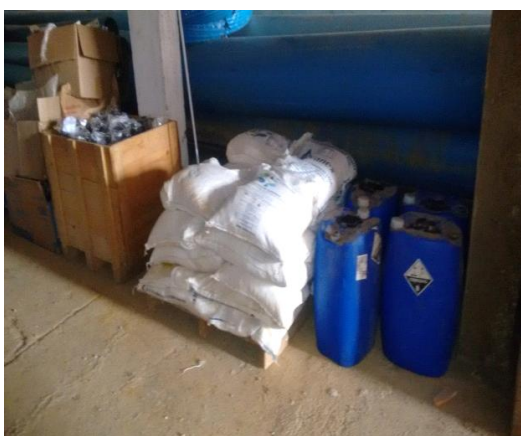
Foto 05: sacos de Sulfato de Alumínio sobre o estrado e armazenamento de Cloro em galões – conformidade .
