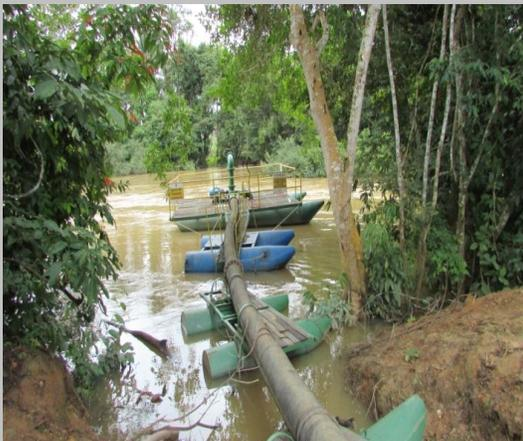
Foto 03: flutuante em funcionamento sem plataforma e passarela de acesso – não conformidade.
