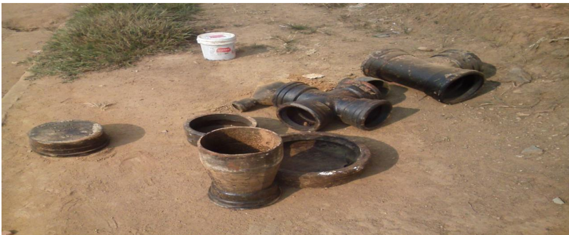
Foto 02: uma cruzeta de 200mm de ferro fundido RD 200x150, uma RD 300x200, e um (T) de 200mm de ferro fundido com RD 200x50.
