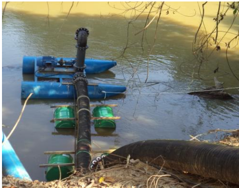
Foto 01: flutuante improvisado equipado com moto bomba já inoperante.
