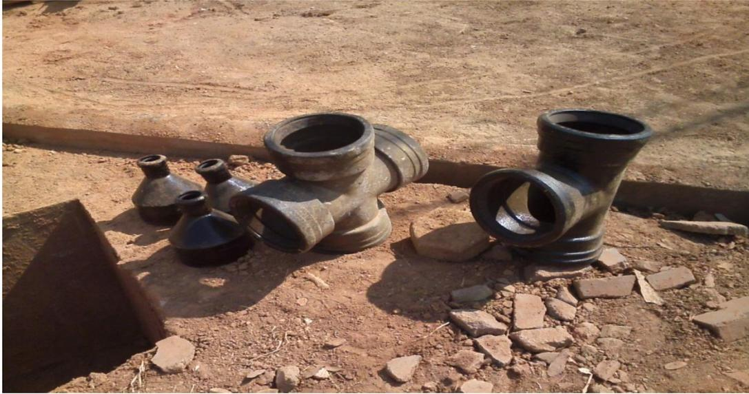
**9ª foto: uma cruzeta, um (T) de ferro fundido de 200mm e três reduções de 50mm de ferro fundido.**
